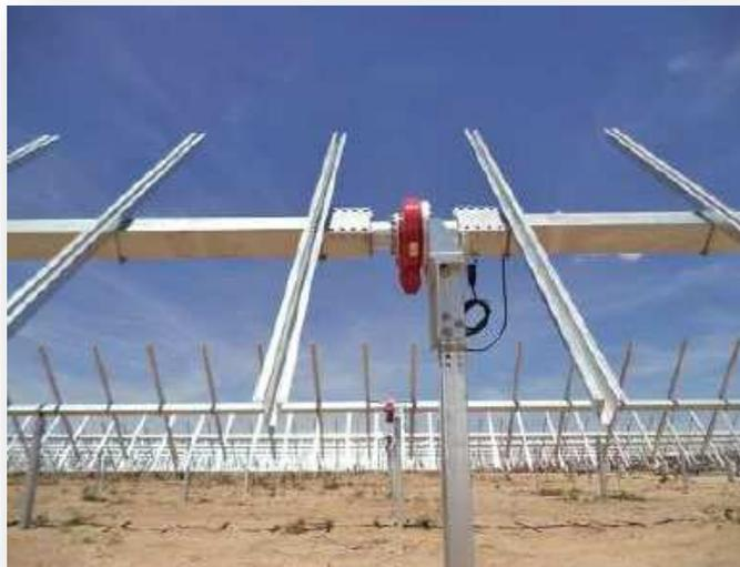
Figura 25- Struttura dell'inseguitore solare monoassiale
