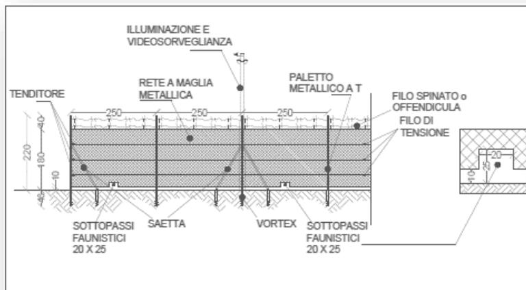
Figura 28- elaborato 53 (DISEGNI ARCHITETTONICI Recinzione tipo impianto fotovoltaico)
