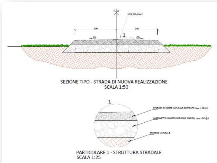
Figura 33- Estratto elaborato 27 (Sezione stradale tipo)
