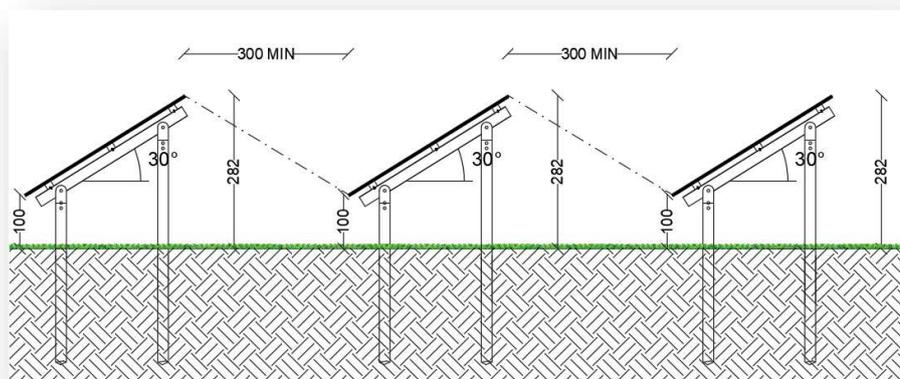
**Figura 27- Sezione tipo impianto con installazione su strutture ad orientamento fisso**
