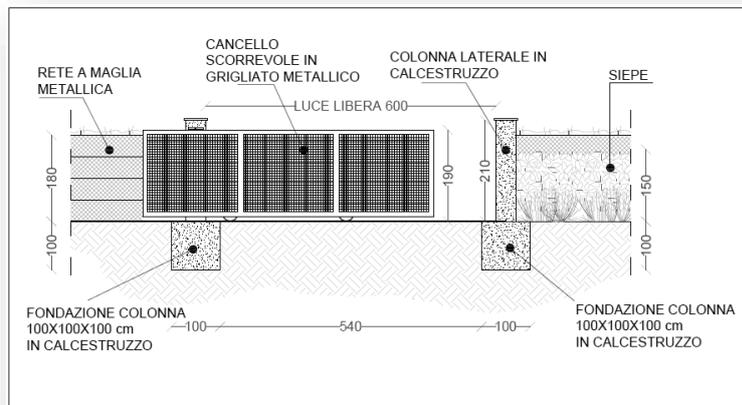
**Figura 29- elaborato 53 (DISEGNI ARCHITETTONICI Recinzione tipo impianto fotovoltaico)**
