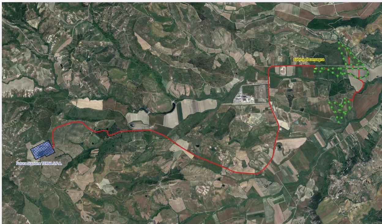
Figura 1 - Percorso dell'elettrodotto interrato AT da realizzare (tratto in rosso)
