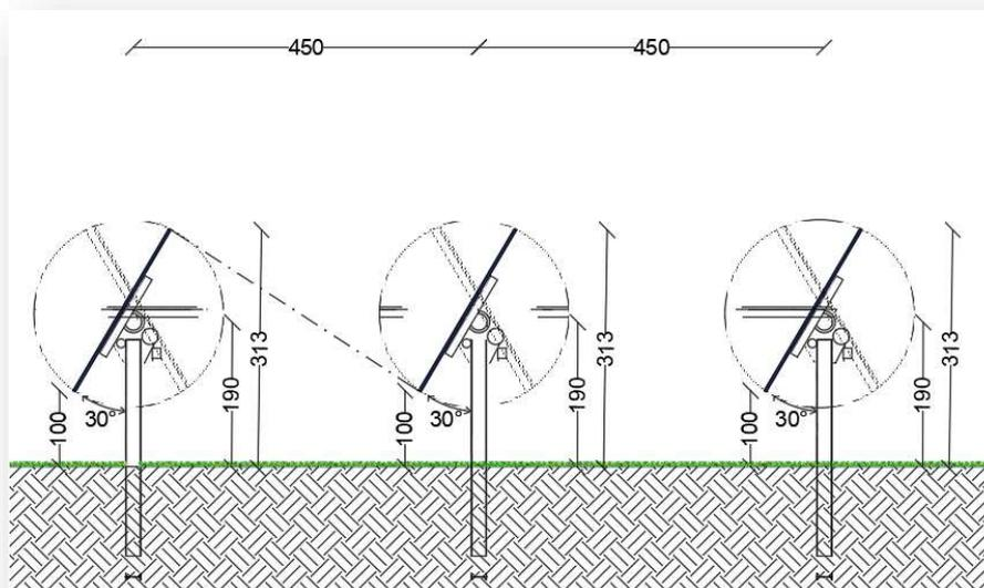
Figura 26– Sezione tipo impianto nella configurazione tracker
