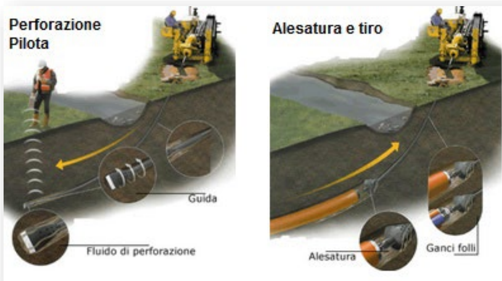
Figura 24- Tecnologia di trivellazione orizzontale controllata (TOC)
