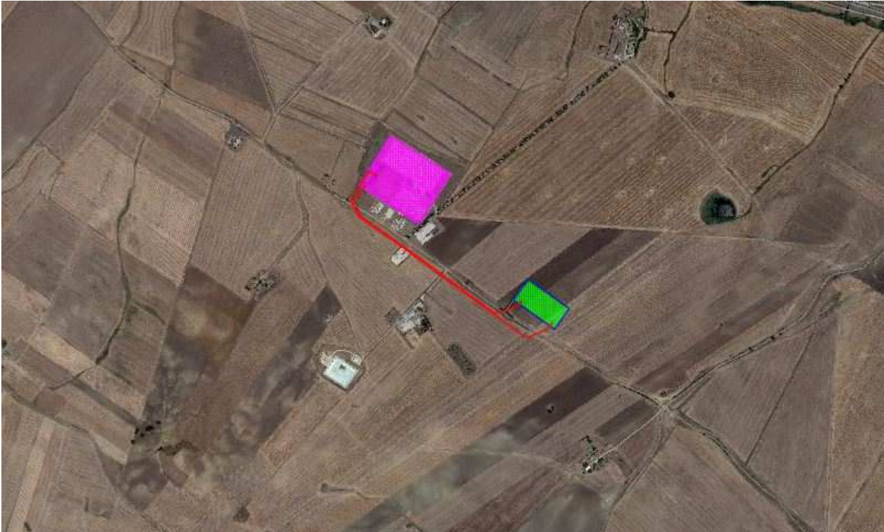
Figura 3 – individuazione del tracciato dei nuovi raccordi interrati per il collegamento del nuovo satellite a 150 kV alla SE RTN di Genzano (PZ) su ortofoto
