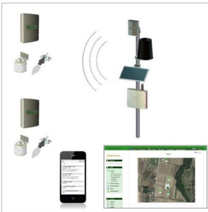
Figura 14 - Stazione principale e sensori meteo climatici
