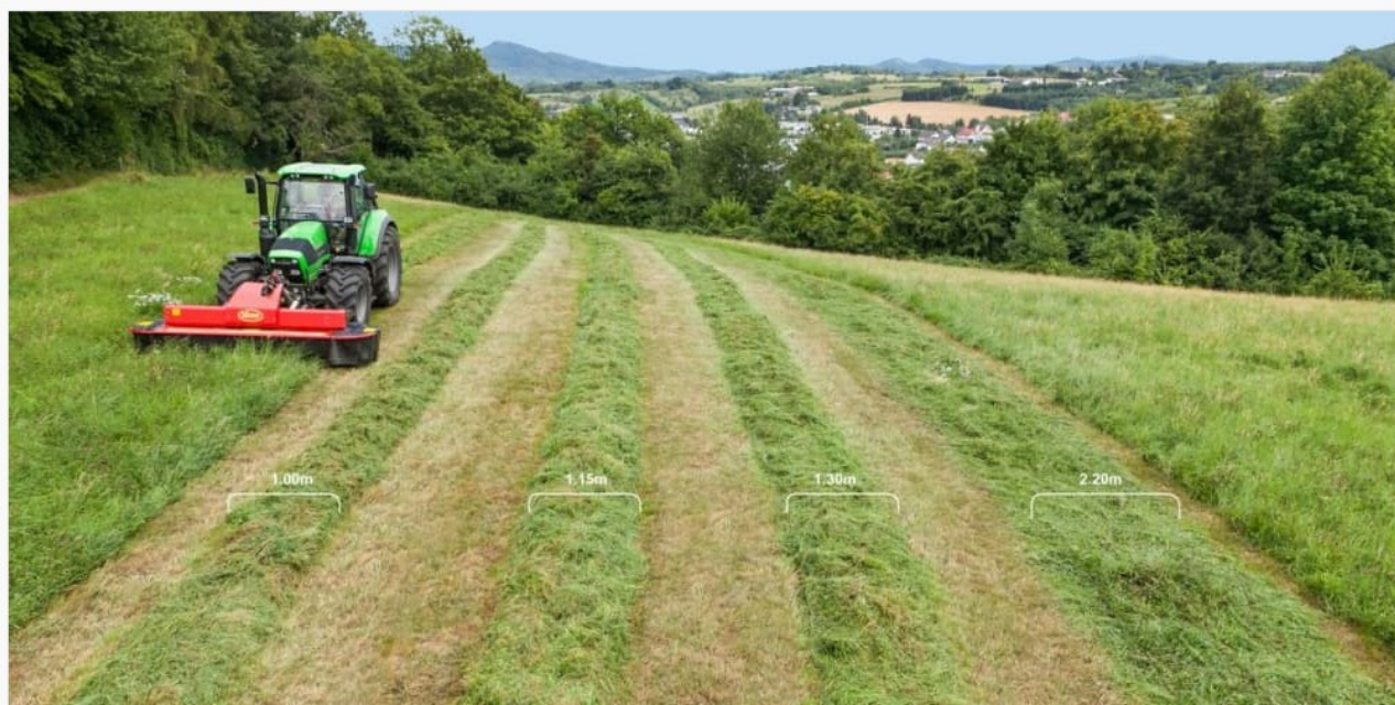
Figura 13 - Immagine della falciatrice anteriore e larghezze delle andane realizzabili
