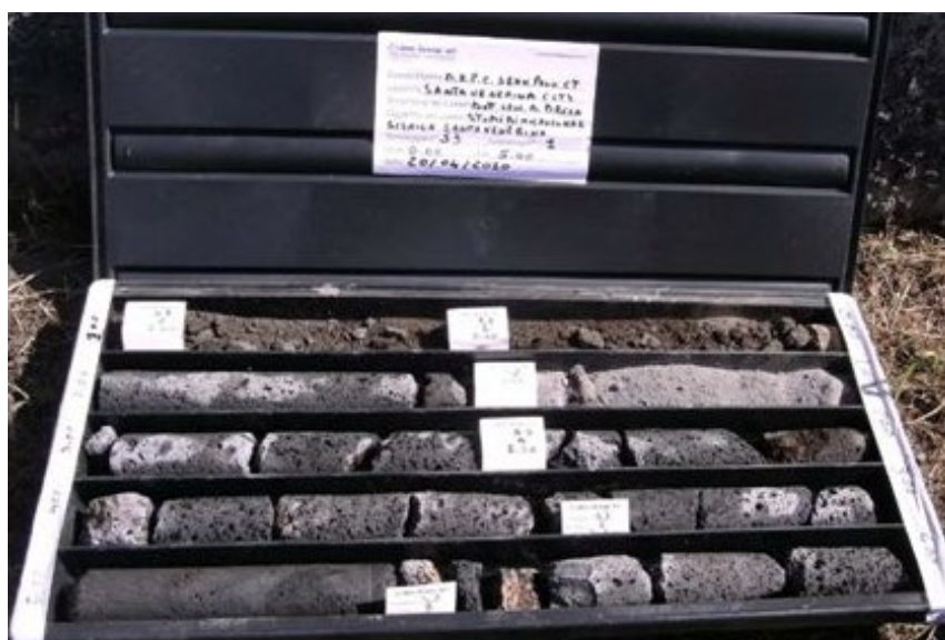
Figura 1 - Sondaggio verticale con carotiere
