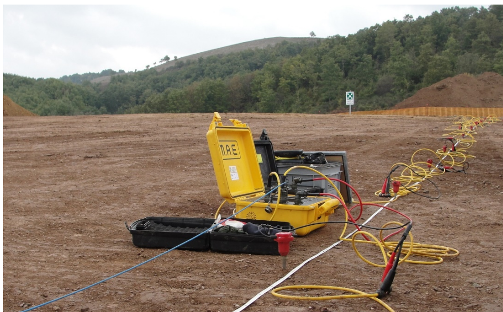
Figura 2 - Indagine sismica - Down Hole
