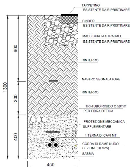
Lungo tutto lo scavo dei collegamenti tra gli aerogeneratori sarà posata una corda in rame nudo di sezione 50 mm<sup>2</sup> per la messa a terra dell'impianto.
