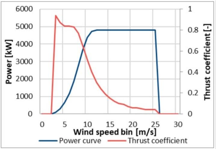
Poiché la potenza estraibile da un flusso eolico è direttamente proporzionale alla densità dell'aria, nel caso in cui essa, nelle aree relative al sito in questione, si scosti dal suddetto valore standard è necessario correggere le curve di potenza e del coefficiente di spinta in riferimento alla densità realmente rilevata.
