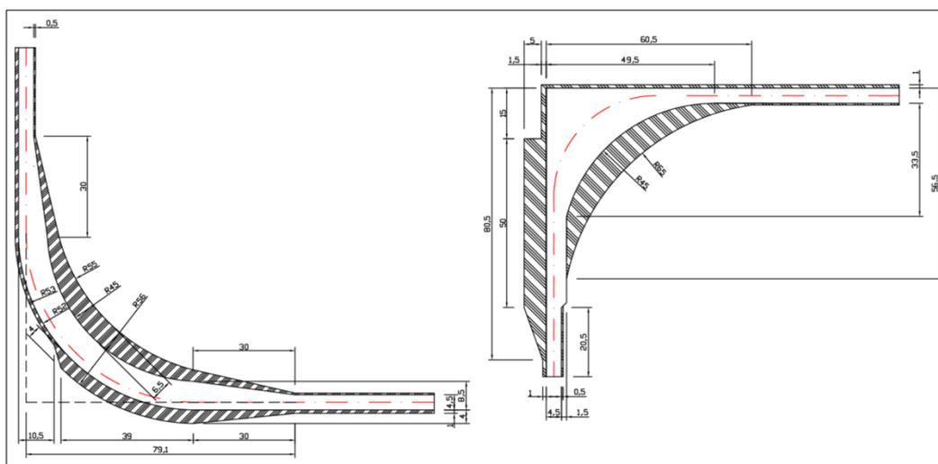
*Figura 10 - Particolare realizzazione raccordo strade*
