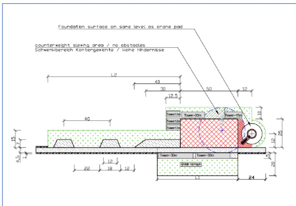
Figura 14 - tipologico della piazzola di montaggio
