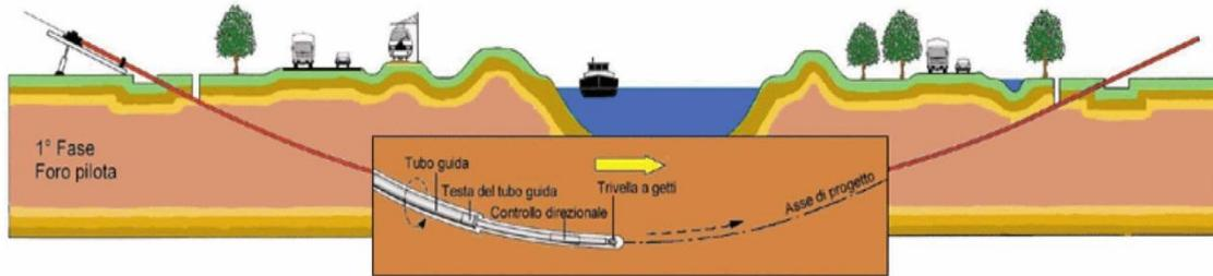
**Figure 10 Schema della fase di realizzazione del foro pilota.**
