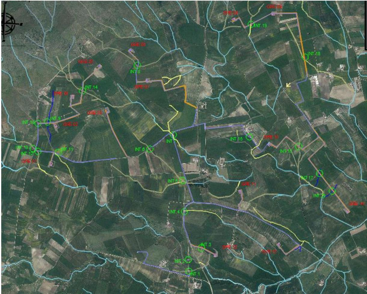
**Figure 7 Inquadramento delle turbine in progetto e delle interferenze con individuazione del reticolo idrografico IGM E ortofoto.**
