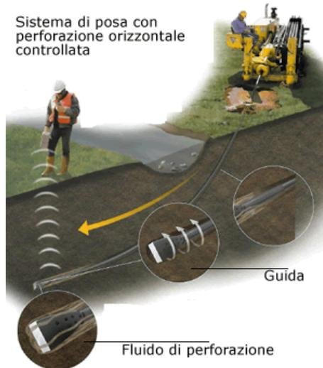
**Figure 9 Sistema di trivellazione orizzontale controllata (T.O.C.).**
