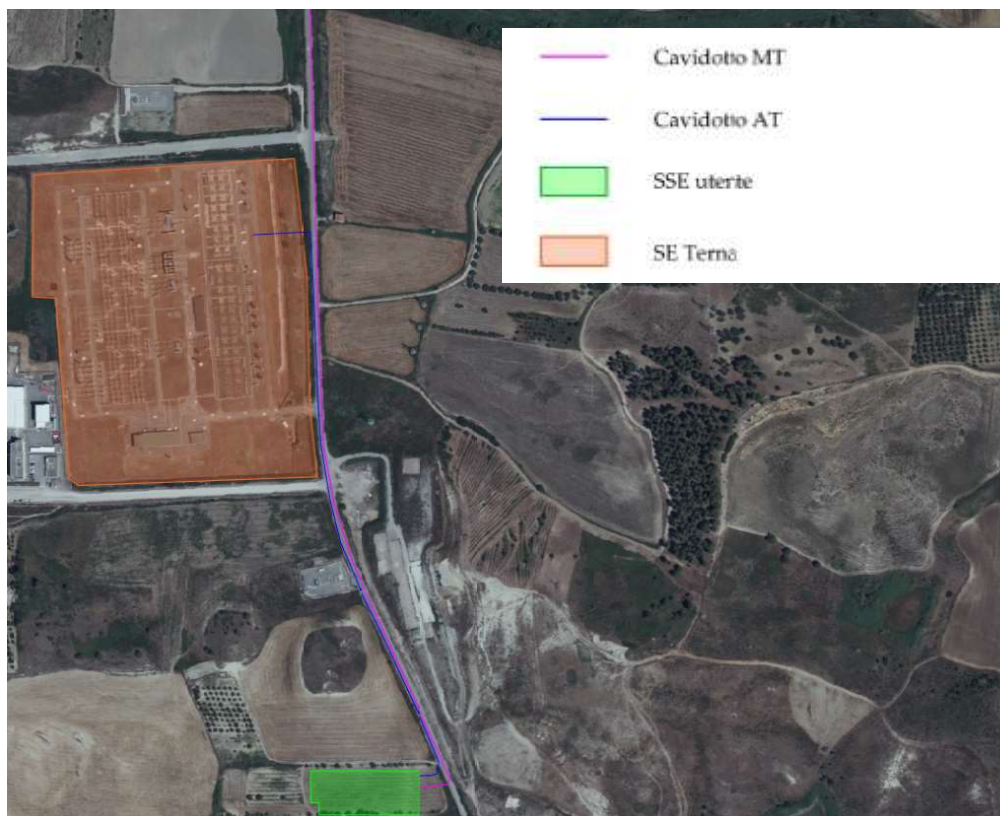
Figura 20: Inquadramento su ortofoto SSE elettriche in progetto
