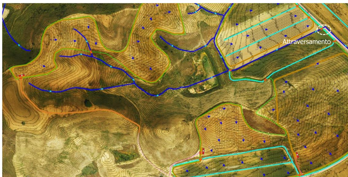
Figura 5.9. Stralcio della planimetria Sud delle interferenze (in arancione) tra la rete idrografica esistente (linee blu e azzurro) con la viabilità interna (linee beige). Cerchiato in bianco si evidenzia l'attraversamento sull'impluvio del "Bacino SW", discusso nel seguito.
