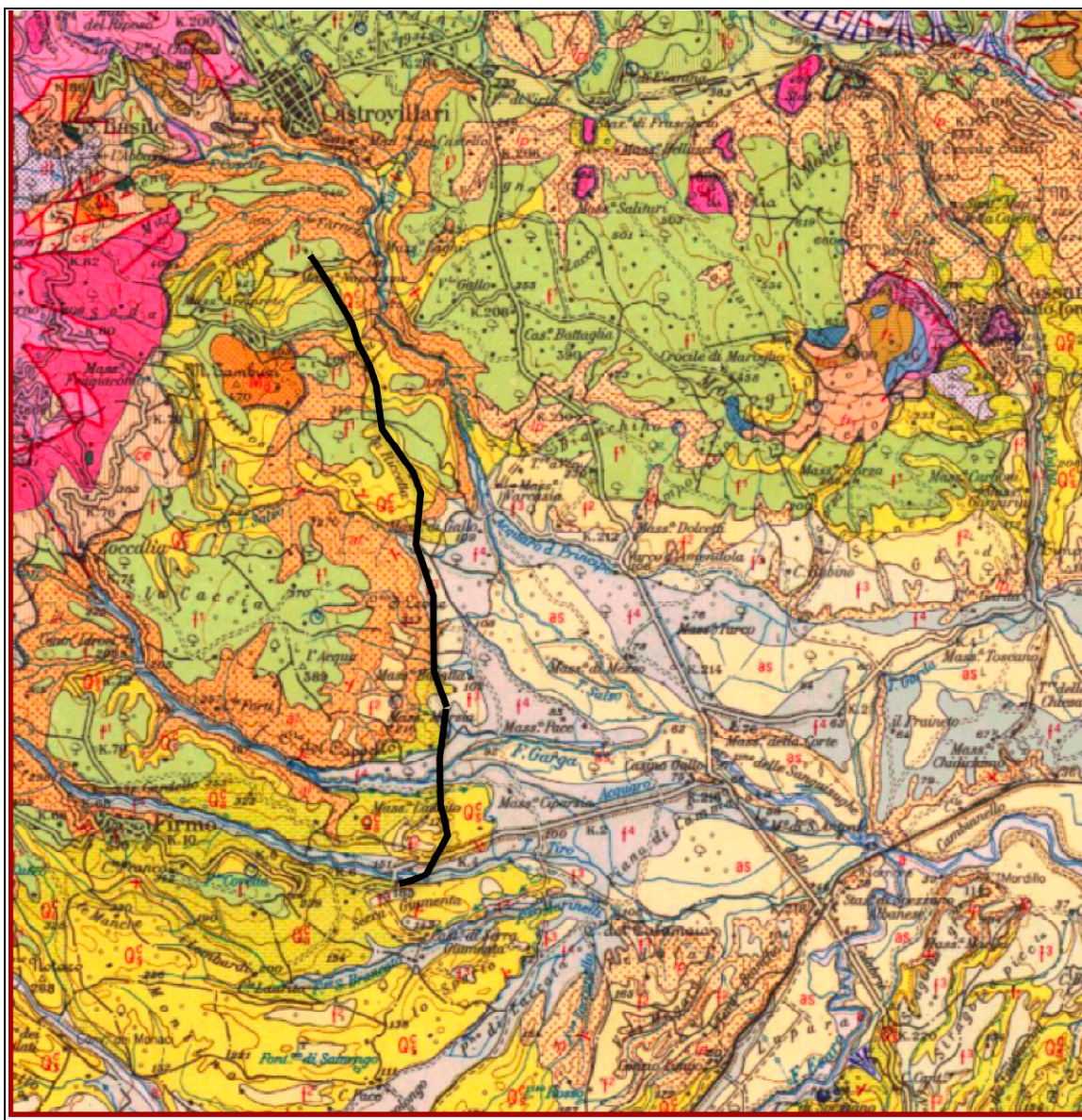
Fig. 5-I: Ritaglio del Foglio 221 della Carta Geologica d'Italia 1:100000, con il tracciato dell'elettrodotto Laino-Altomonte 2.
