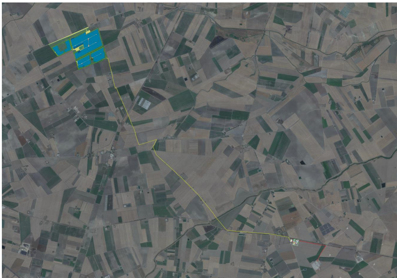
Figura 3-1: Localizzazione area di intervento, in blu la perimetrazione del sito, in giallo e in rosso il tracciato della connessione in media e in alta tensione
