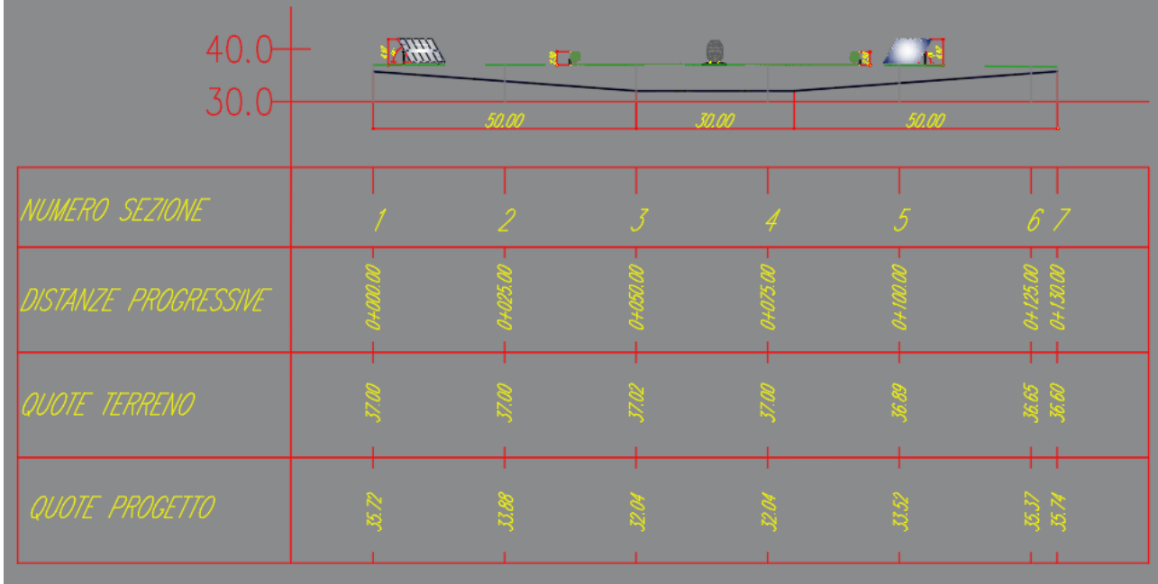
Figura 2-12: Sezione Attraversamento Rete Ferroviaria
