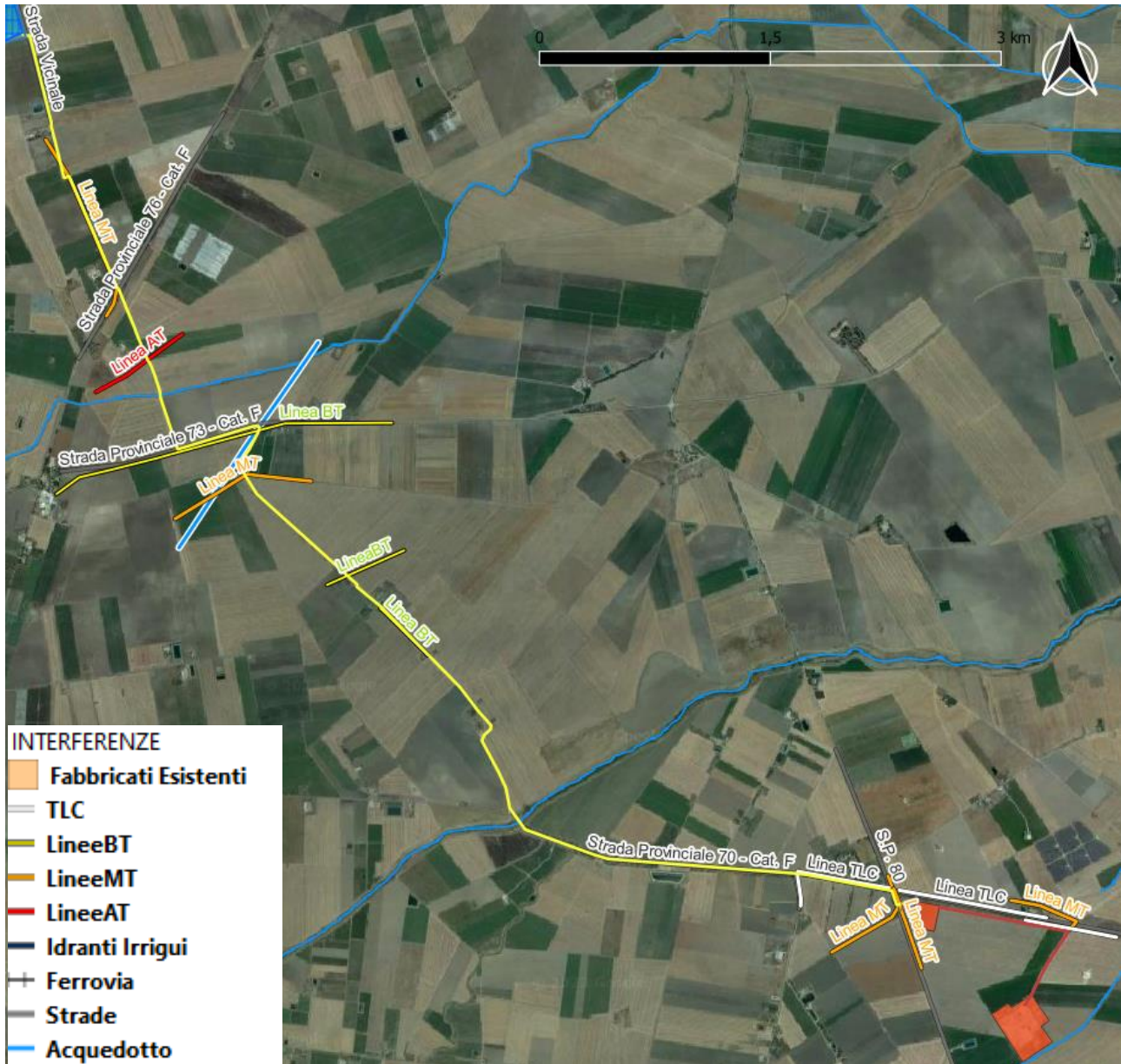
Figura 2-14: Inquadramento elettrodotto e individuazione delle interferenze
