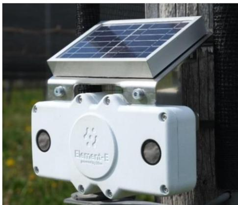
**Figura 23** - Spectrum installato su un palo di legno. Si notino i due microfoni circolari inseriti nella cassa bianca, e il pannello solare posizionato superiormente.
