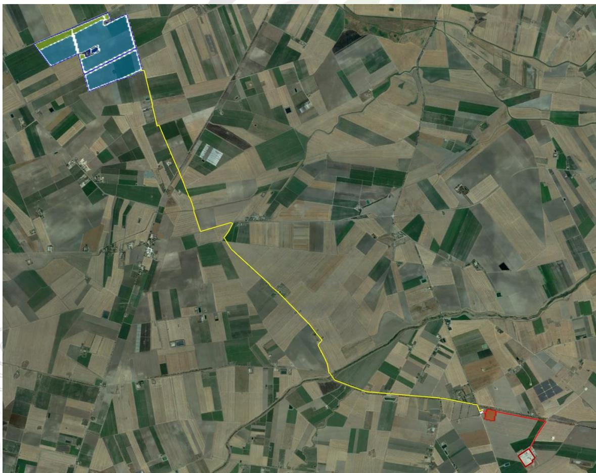
Figura 3-1: Localizzazione area di intervento, in blu la perimetrazione del sito, in giallo il tracciato della connessione in cavo interrato in Media Tensione e in rosso in Alta Tensione
