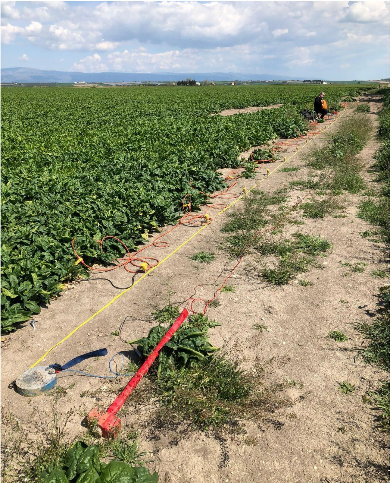
STENDIMENTO SISMICO CC' – 36 m
