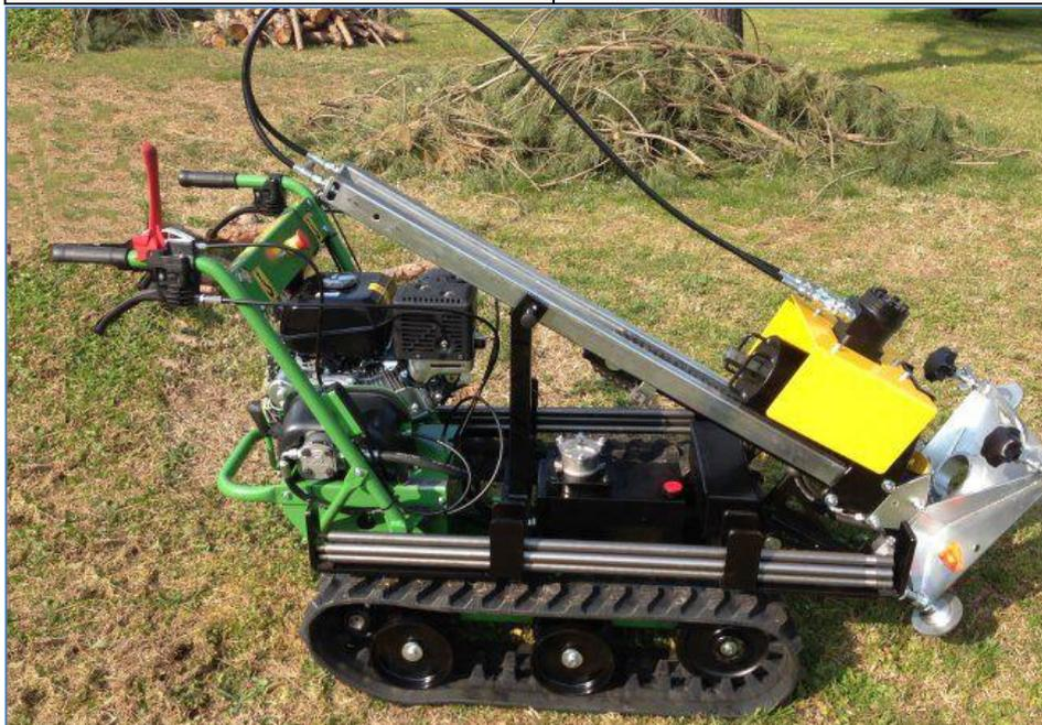
La resistenza opposta dal terreno alla punta conica viene correlata alle caratteristiche fisico-meccaniche e portanti del terreno, consentendo inoltre di riconoscere, con buona approssimazione, la stratigrafia del sottosuolo; il tutto fino alla profondità a cui la resistenza del terreno è tale da non permetterne più l'infissione (rigetto della punta).
