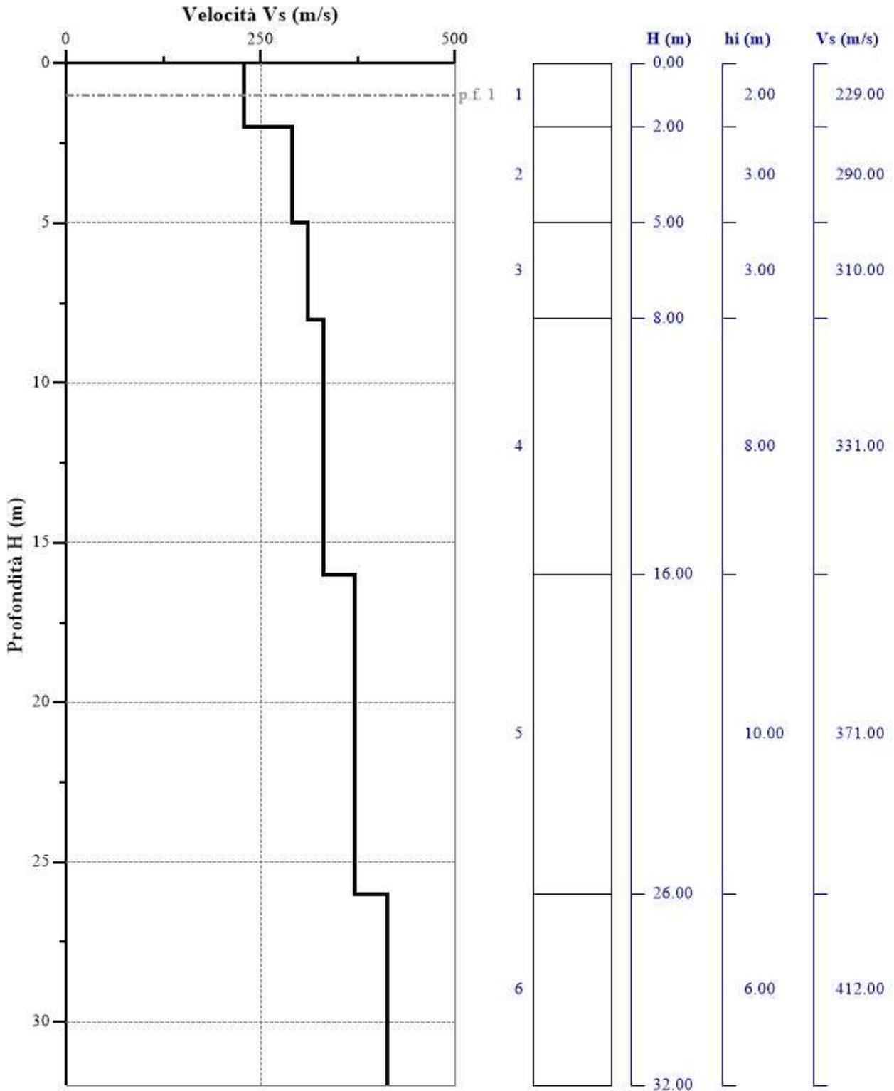
Fig.22 - Profilo verticale delle velocità delle Onde registrate
