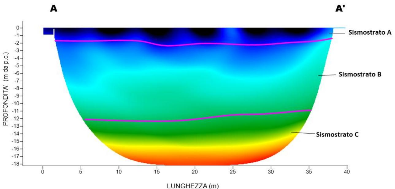
Fig. 9 – Interpretazione sezione tomografica del profilo AA'
