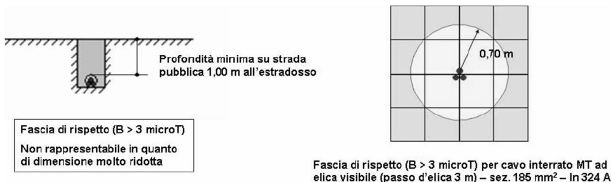
Per quanto riguarda tutti i cavi, interrati in cavo cordato ad elica, si fa riferimento al par. 3.2 del DM 29/05/2008, per il quale dette linee sono escluse dal calcolo delle DPA.
