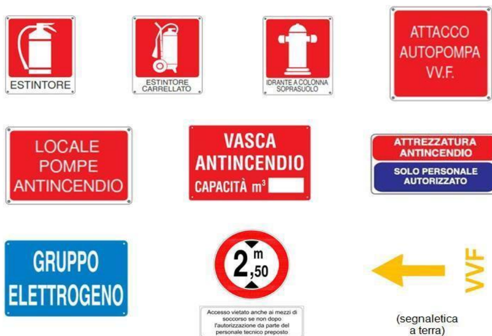
Figura 7- Esempi di segnaletica di sicurezza
