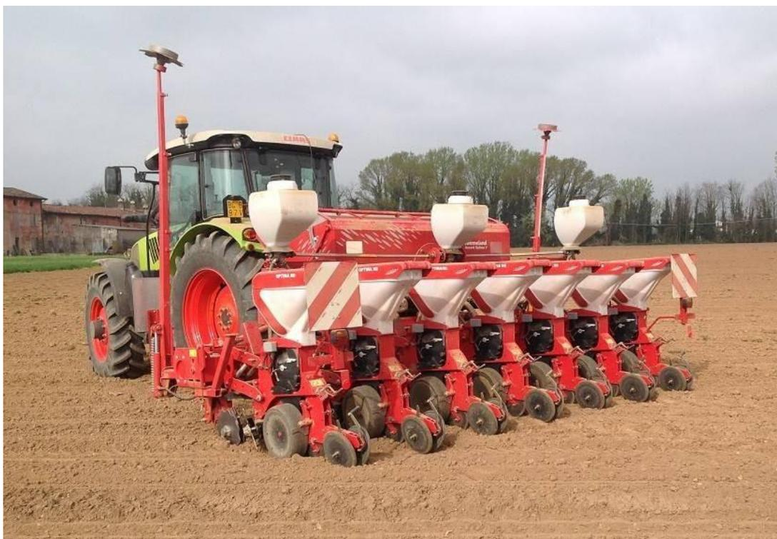
Figura 14 - Tipologia seminatrice di precisione da impiegarsi nella semina delle colture foraggere
