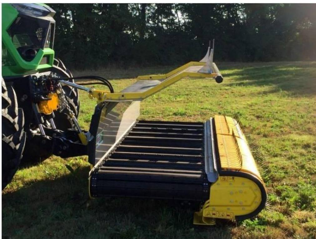
*Figura 16 - Tipologia di ranghinatore a tappeto tipo da impiegarsi nelle operazioni di fienagione*
