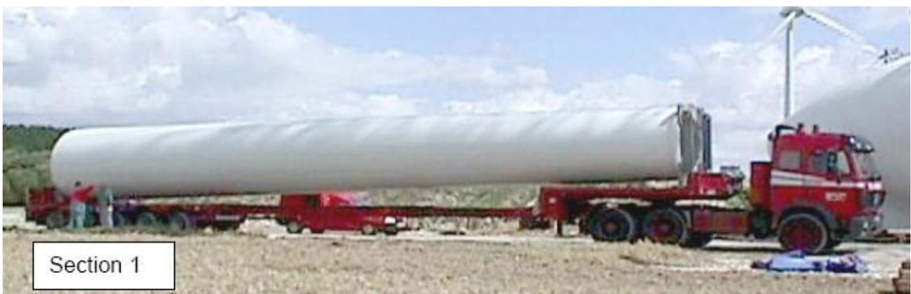
**Figura 12:** trasporto della sezione della torre
