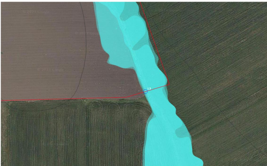
*Figura 18 – Rappresentazione dell'area inondabile ottenuta dalla modellazione idraulica bidimensionale per la I.3*
