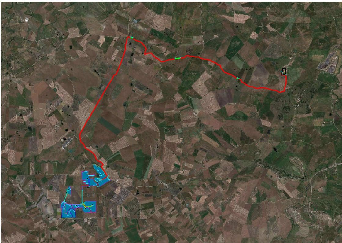
Figura 28. Cavidotto di collegamento alla SE su ortofoto
