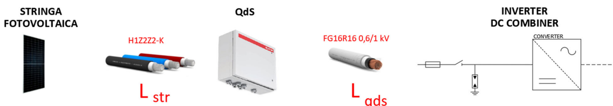
Figura 6 Collegamento elettrico LATO DC
