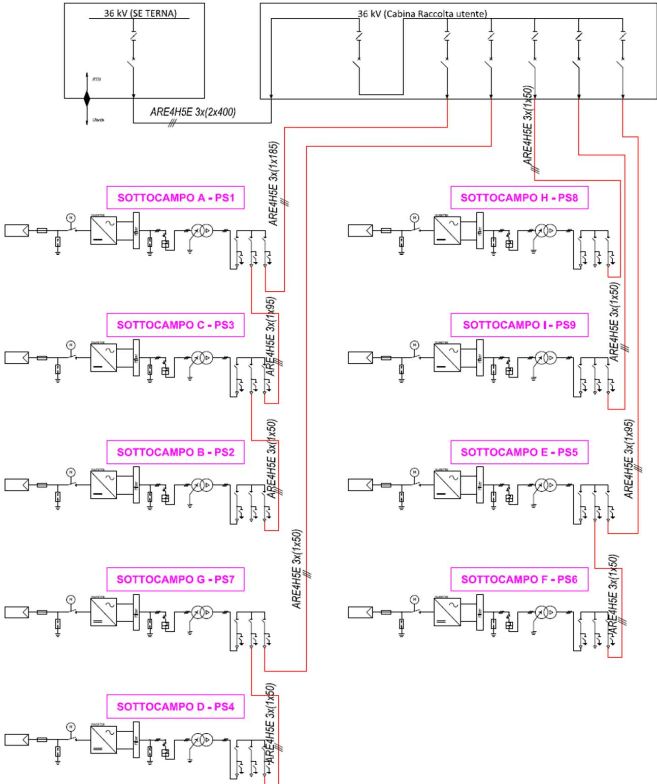
**Figura 2 Unifilare impianto PV con cavi in progetto**
