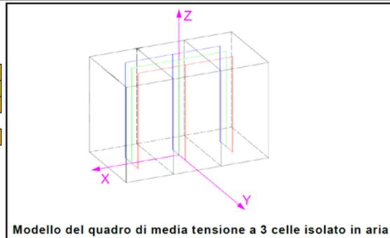
Modello del quadro di media tensione a 3 celle isolato in aria
