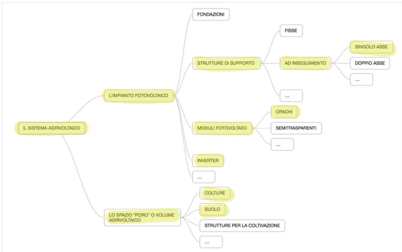
Figura 2. schema scomposizione sottosistemi dell'impianto agrivoltaico tratto dalle *Linee Guida*
