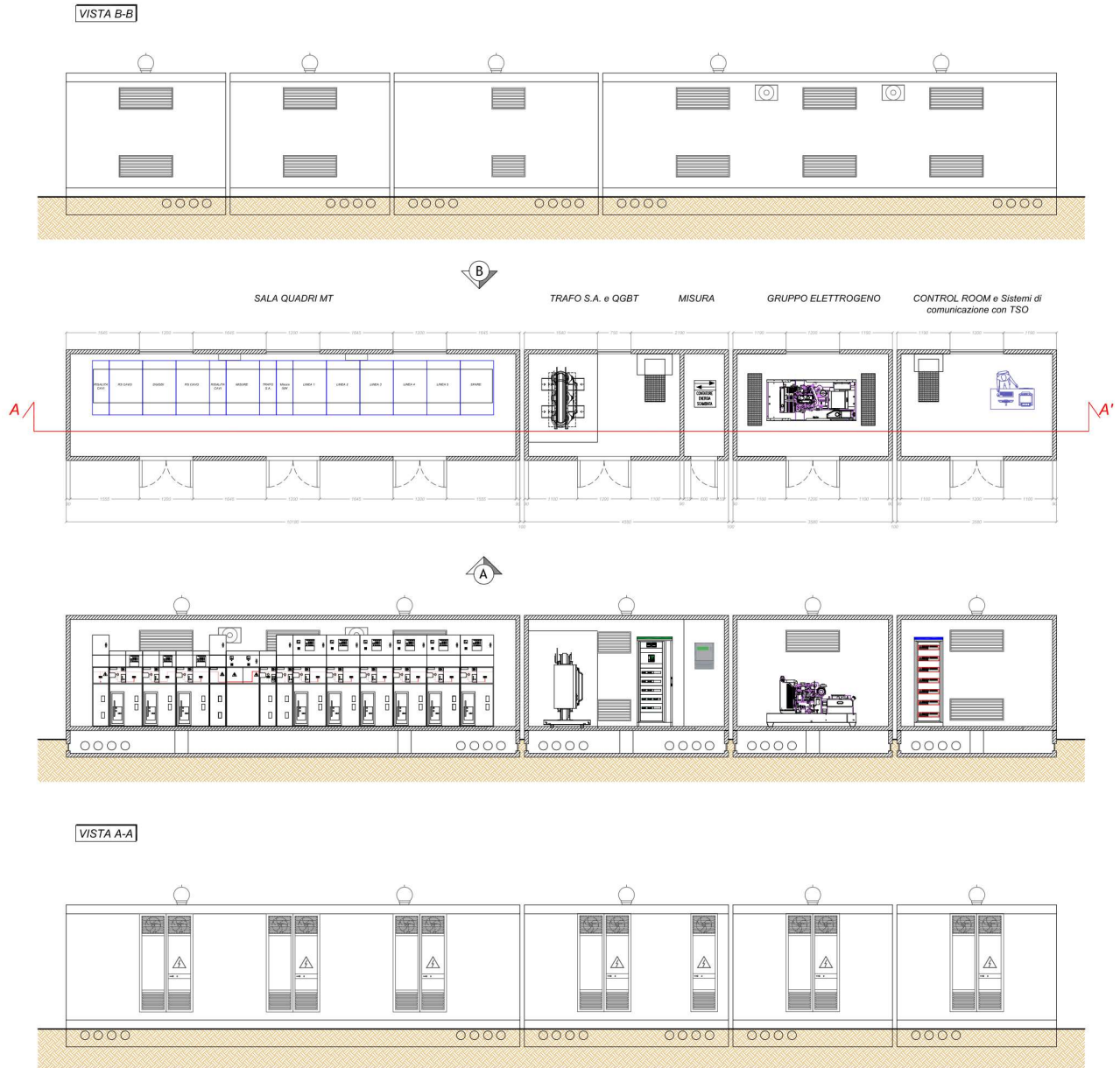
Figura 3.2-1 – Cabina di raccolta e misura
