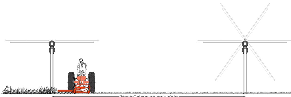
Figura 10 - Particolare in sezione; applicazione macchina agricola in contesto agri-fotovoltaico
