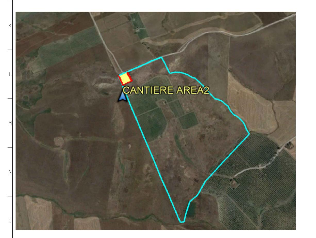
$\underline{\mbox{Allestimento}\ \mbox{del cantiere per le seguenti attiività previste}}\,.$ Movimentazione terra per rettificare il livello Infissione dei pali di struttura con appositi battipali Montaggio delle strutture Posa dei moduli sulle strutture
