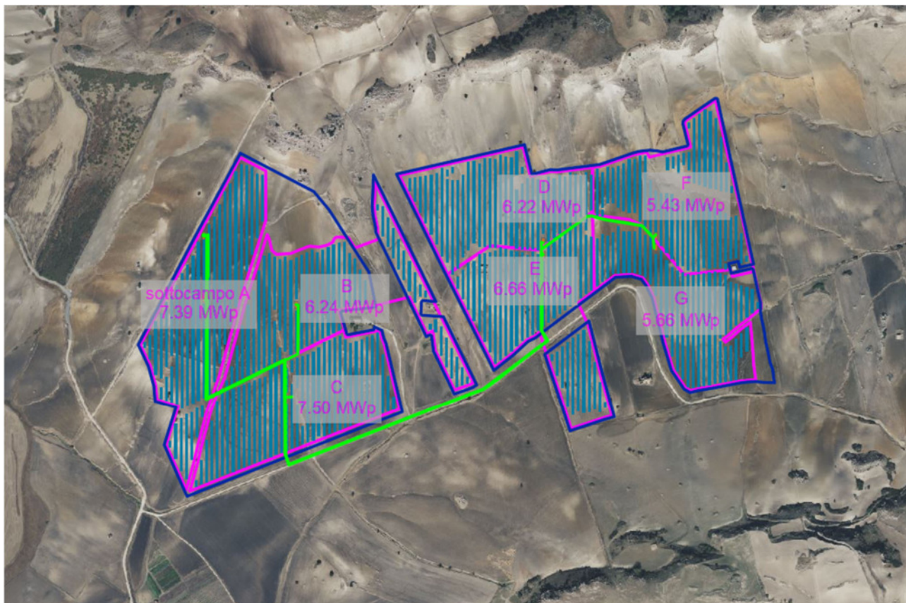
Figura 1 Suddivisione dell'impianto in sottocampi
