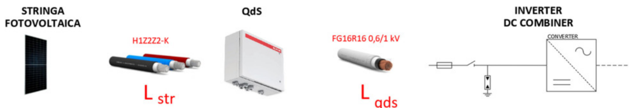
Figura 13 - Collegamento elettrico LATO DC
