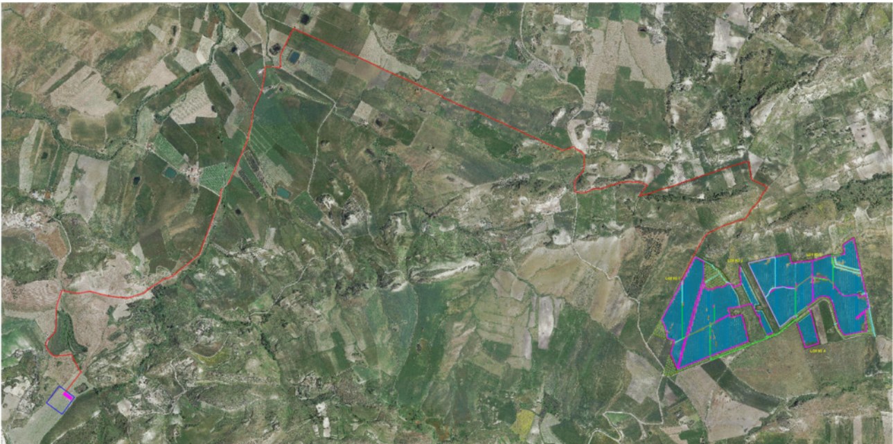
Figura 29. Cavidotto di collegamento alla SE su ortofoto
