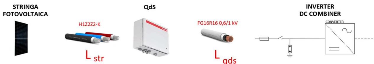
**Figura 6 Collegamento elettrico LATO DC**
