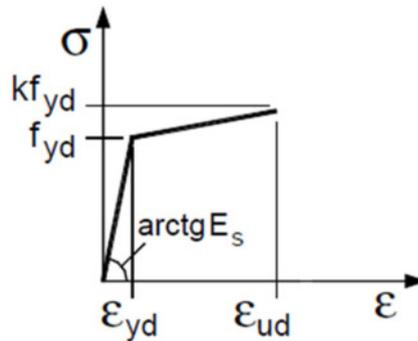
*Figura 2: Legame costitutivo dell'acciaio di tipo bilineare finito con incrudento (Rif. Paragrafo 4.1.2.1.2.2 delle NTC 2018, Figura 4.1.3).*
