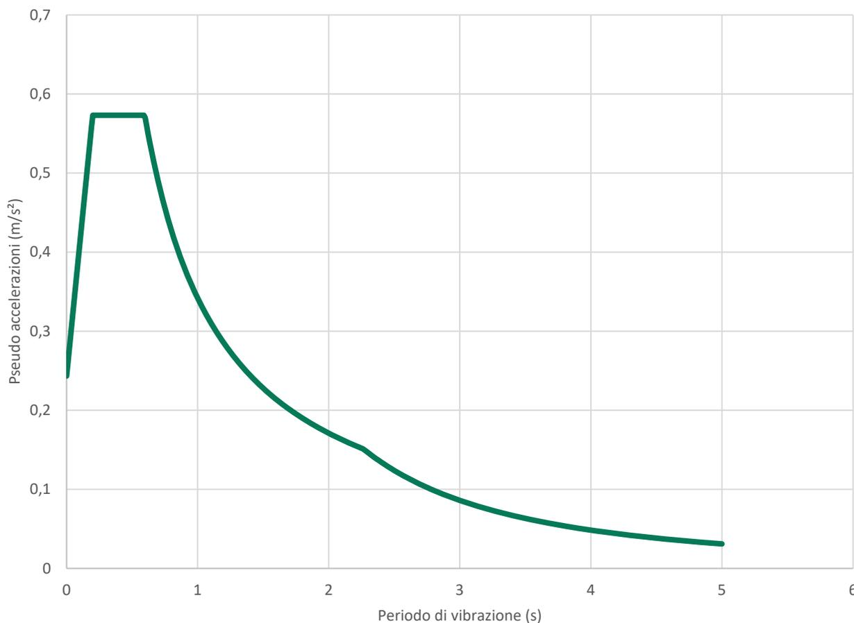
Figura 5: Spettro di risposta elastico in accelerazione delle componenti orizzontali allo stato limite di salvaguardia della vita (SLV)
