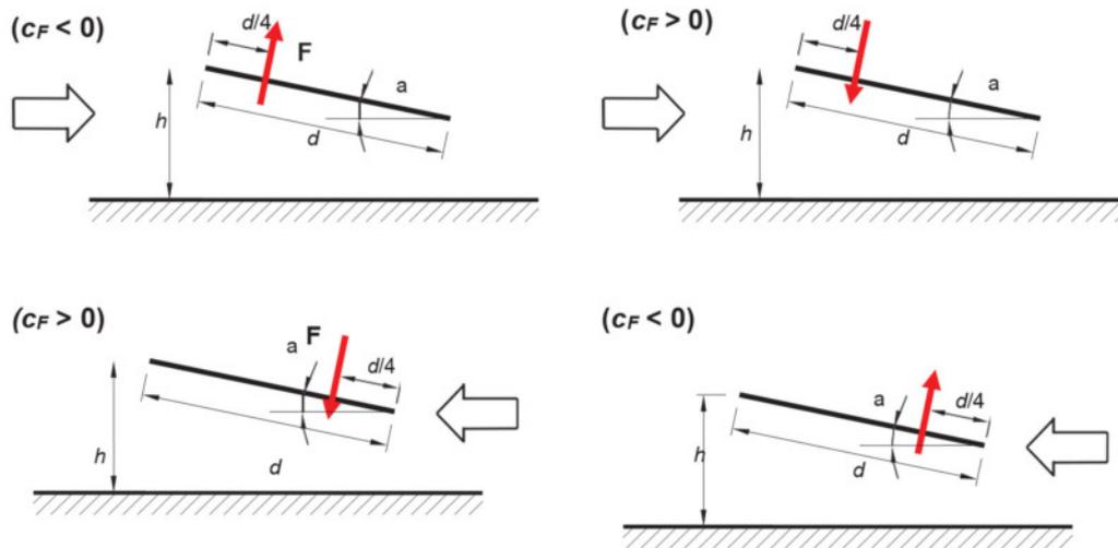
**Figura 4:** (Rif. Figura G.27 NTC) – Tettoie a semplice falda: posizione del punto di applicazione della forza risultante in funzione della direzione di provenienza del vento e della direzione della forza.
