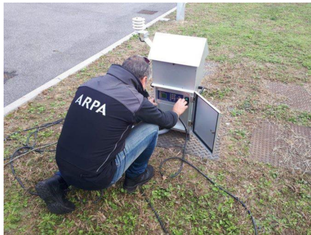
Figura 2 - Esempio di campionatore per il monitoraggio della qualità dell'aria (Fonte: Arpa Lombardia)
