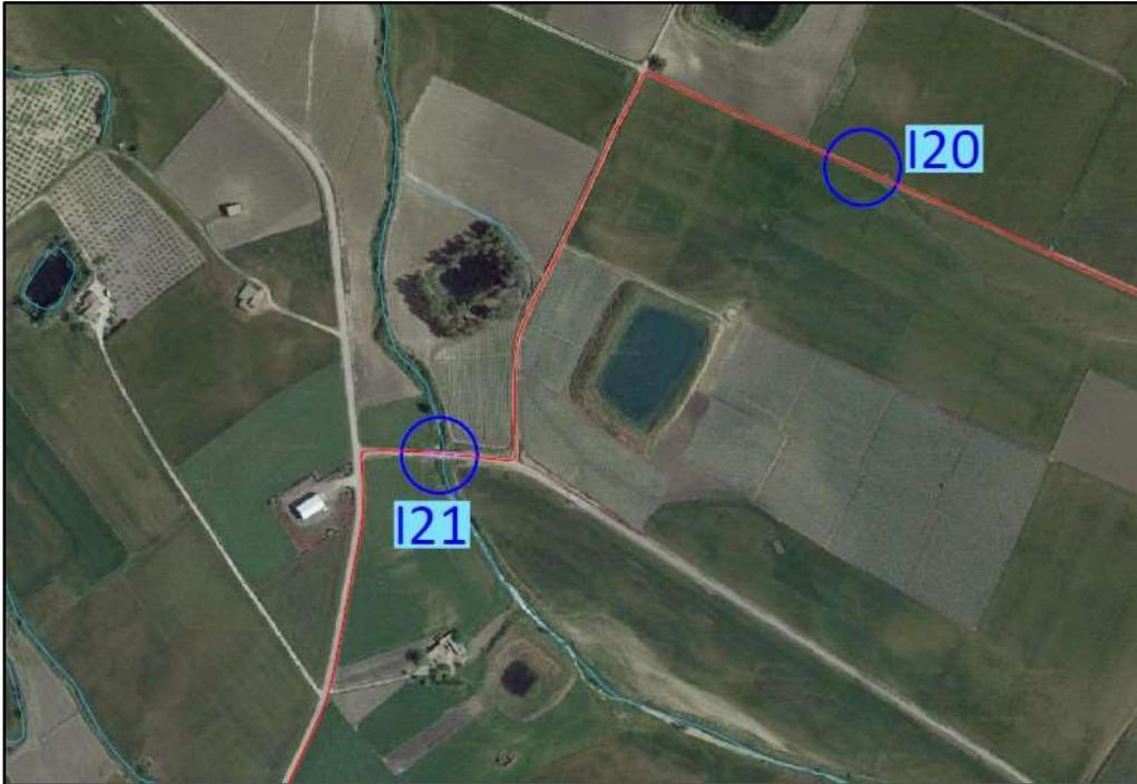
**Attraversamento I21** – Vista planimetrica dell'attraversamento sul corso d'acqua "Gallina" tutelato ai sensi dell'art. 142 lett. C. La linea azzurra rappresenta il corso d'acqua, mentre quella rossa il tracciato del cavidotto. (Rif. Elaborato FV.CLT01.PD.D.G.01.2 INDIVIDUAZIONE PLANIMETRICA DELLE INTERFERENZE PARTE 2 DI 3)
