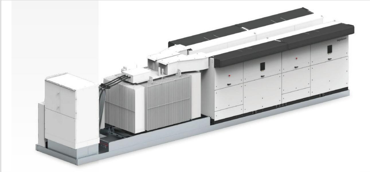
I componenti esterni sono montati su un telaio di base, realizzato in acciaio zincato a caldo. Tutti i componenti compresi gli inverter sono integrati sul telaio di base, completamente cablati e testati in fabbrica, mentre il trasformatore MT viene fornito preassemblato per una connessione veloce in loco.
