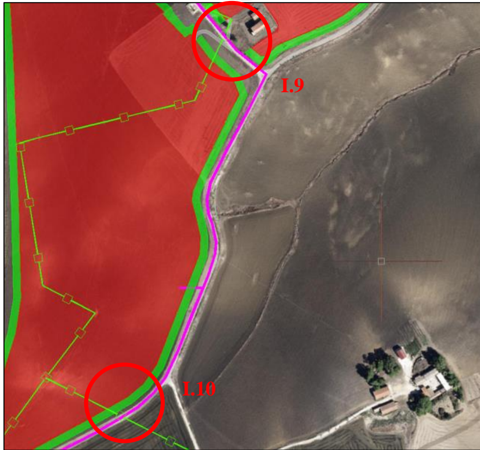
Figura 32: Inquadramento su ortofoto delle interferenze I.9 e I.10 con la condotta indrica
