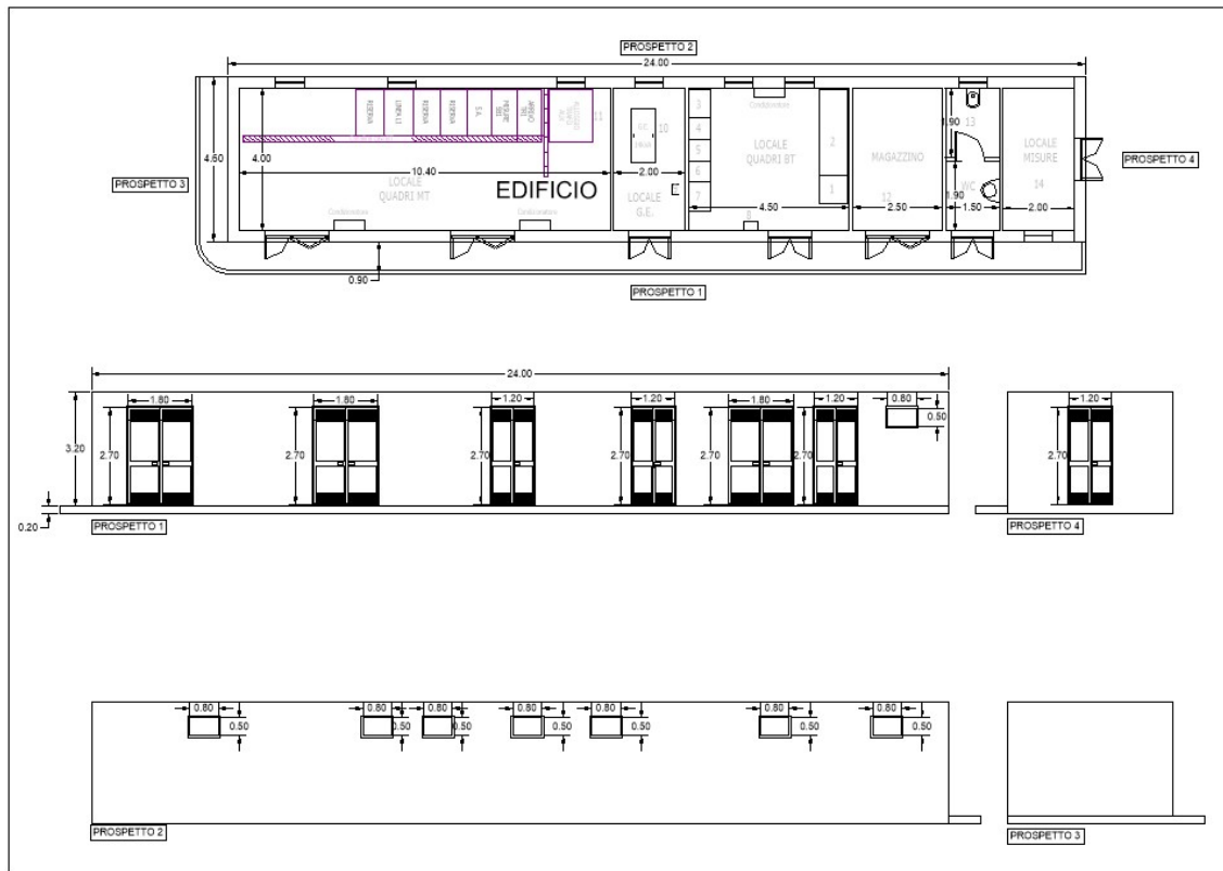
Figura 9: Pianta e prospetti fabbricato Sottostazione elettrica
