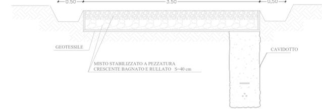
SEZIONE TIPO CAVIDOTTO
