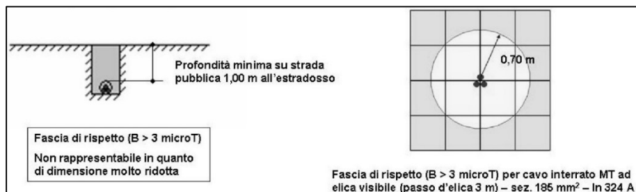
Figura 6: Estratto della guida di Enel sul calcolo della DPA: cavi in media tensione interrati
