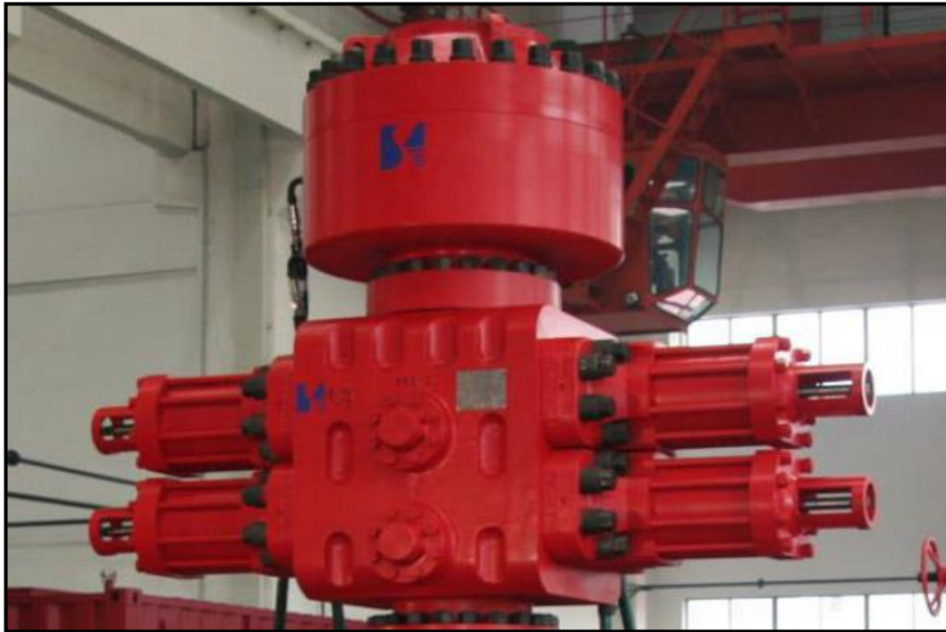
Figura 5.4.2.a Esempi di BOP "ram" e "Annular"
