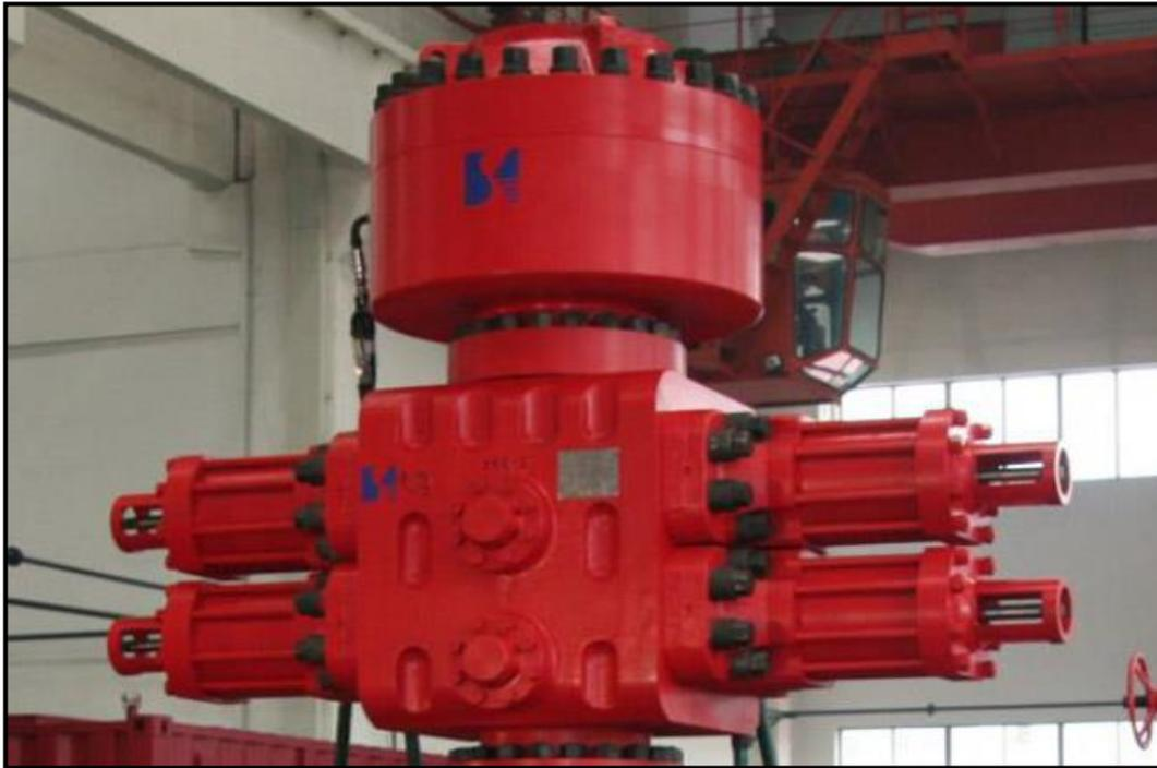
**Figura 3.5.5.2.a** Esempi di BOP "ram" e "Annular"
