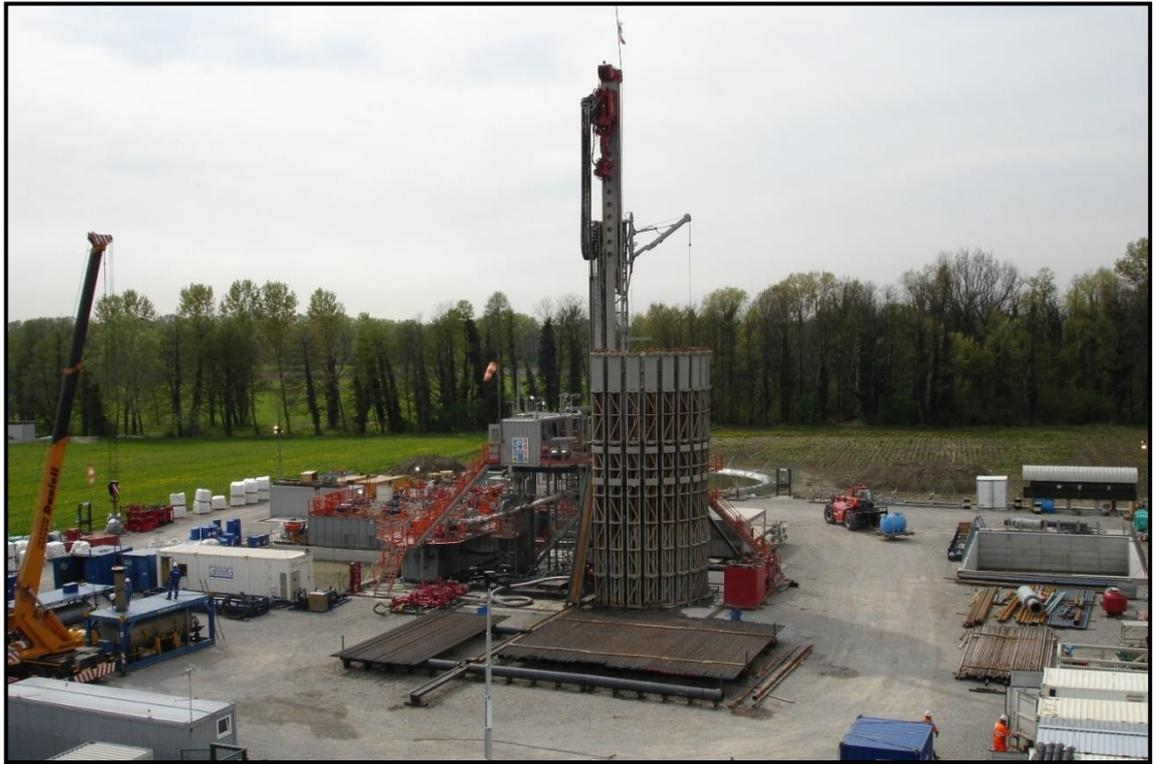
**Figura 3.5.3.a** *Esempio di un Impianto Drillmec HH200*
