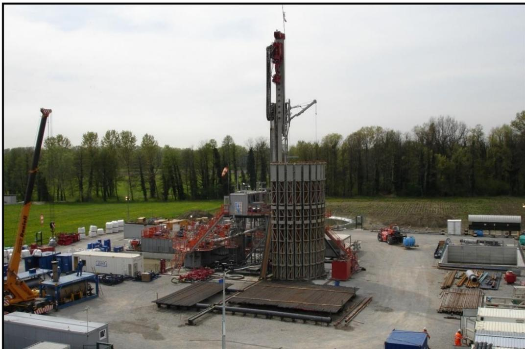
**Figura 3.2.a** Esempio di un Impianto Drillmec HH200
