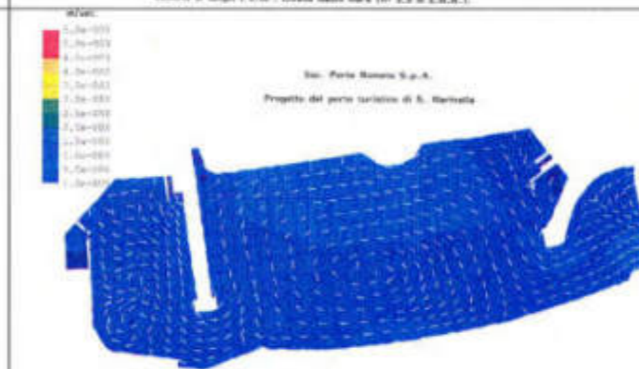
Fig. 8 - Simulazione del campo idrodinamico. Effetto combinato della marea e della circolazione forzata. Distribuzione della velocità al tempo 2:00. Massimo livello di marea (h = 0,15 m s.m.s.l.).
