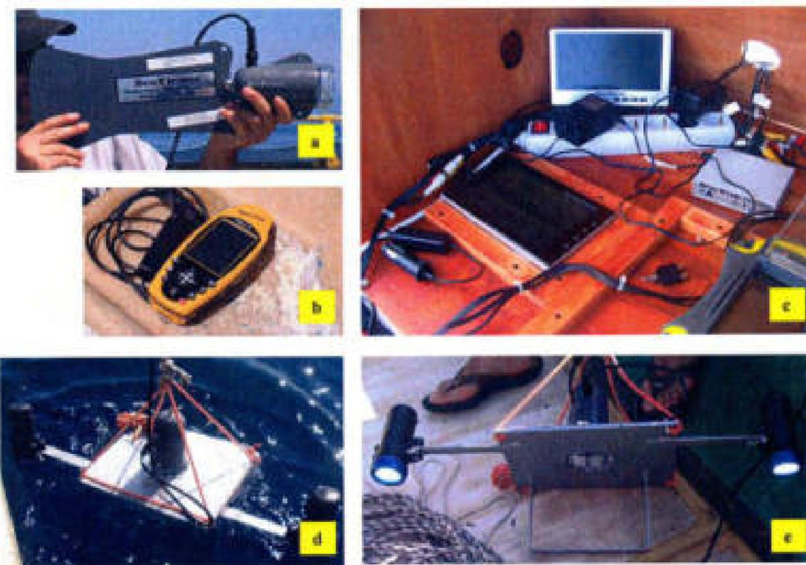
Figura 2 - a) telecamera SeaViewer ® ; b) GPS SporTrak, c) gruppo di acquisizione SeaViewer ® composto da monitor TFT e da video recording DVR corredato da sistema di georeferenziazione SeaTrak GPS Overlay; d-e) particolare della telecamera SeaViewer ® montata su piastra.
