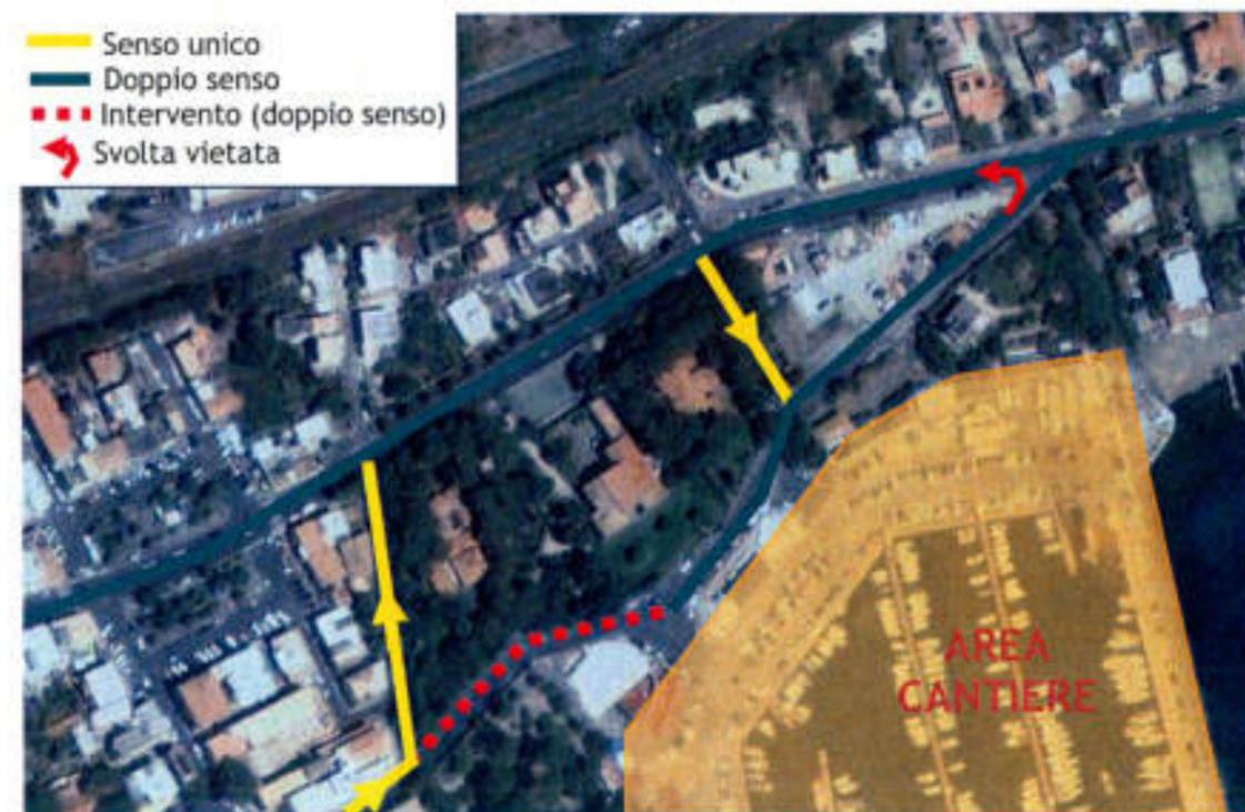
**Figura 5** - Schema di circolazione per la Fase di Cantierizzazione -
