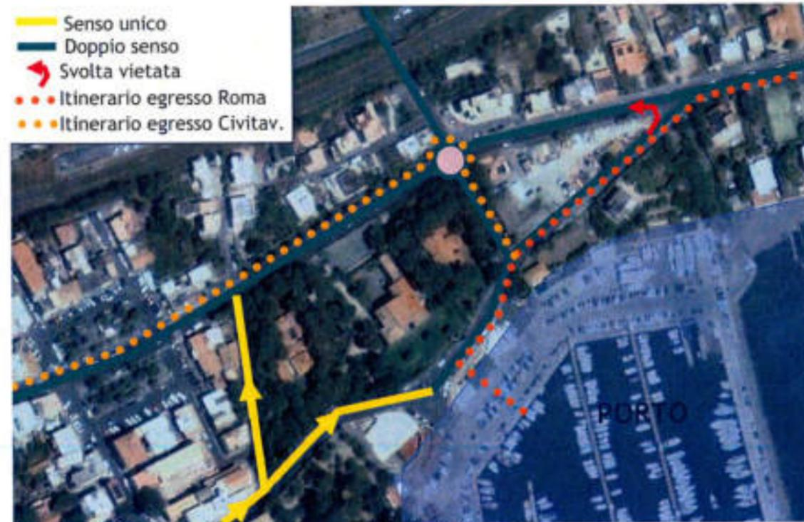
Figura 10 - Schema di circolazione per lo Stato di Progetto -
