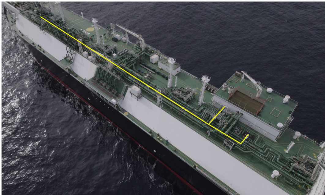
Figura 25 - Fotografia FSRU Tundra – linee di BOG
