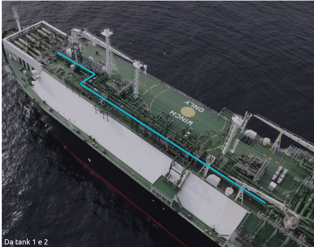
Figura 16 - Fotografia FSRU Tundra – Linee di mandata pompe LNG Feed e collettore GNL alimentazione sezione rigassificazione (da serbatoi 1 e 2)
