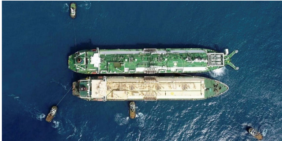
Figura 50 - Affiancamento navi per operazioni STS
