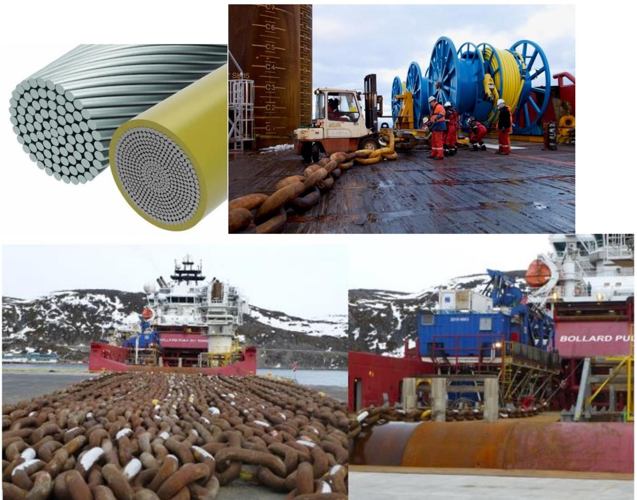
**Figura 5-6** Tipici elementi di ormeggio stivati a bordo di una nave d'installazione
