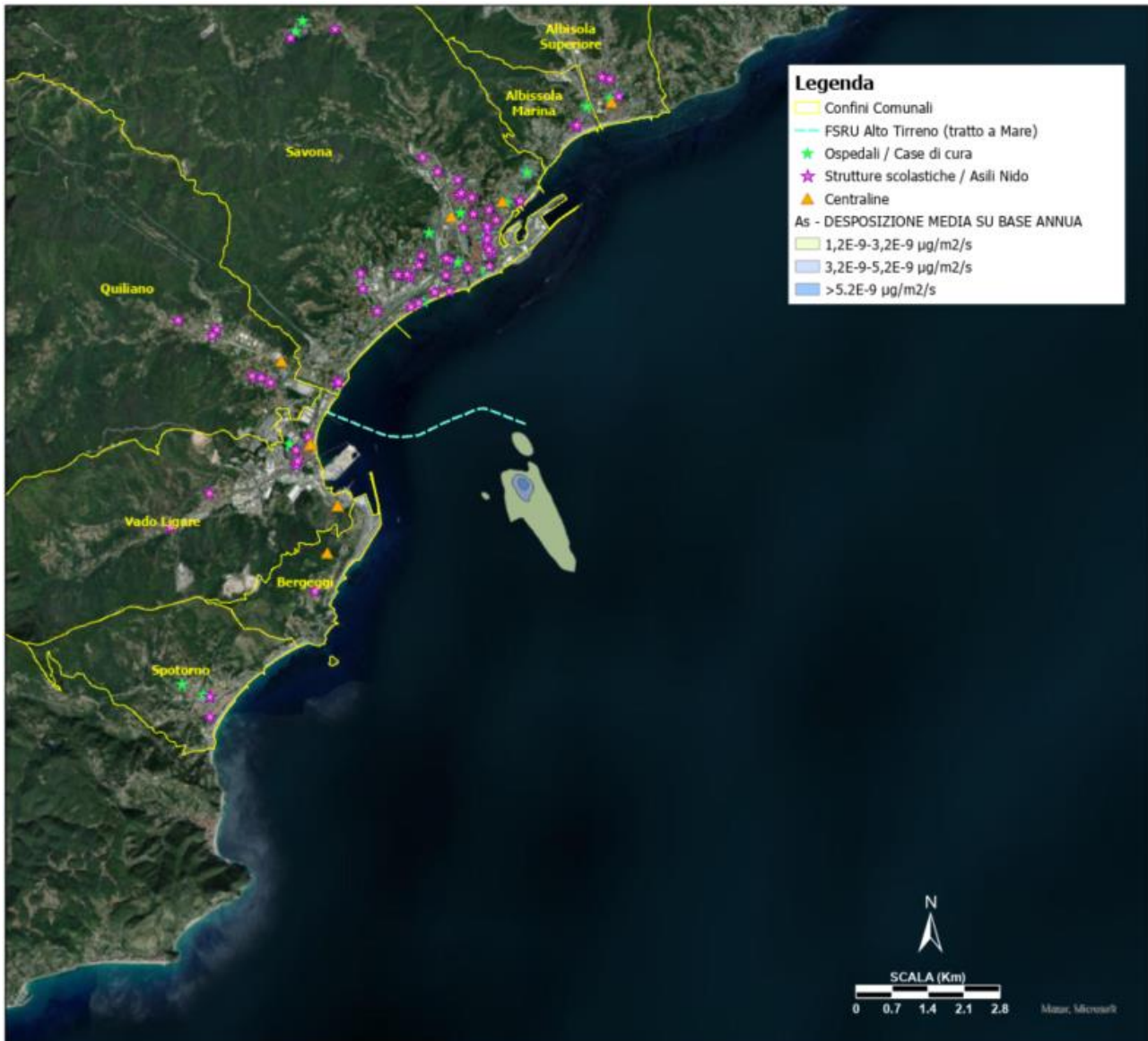
Figura 5-21: Scenario Medio Annuo – Deposizione media su base annuale di As (Valore di Riferimento: 4 µg/m2/gg)
