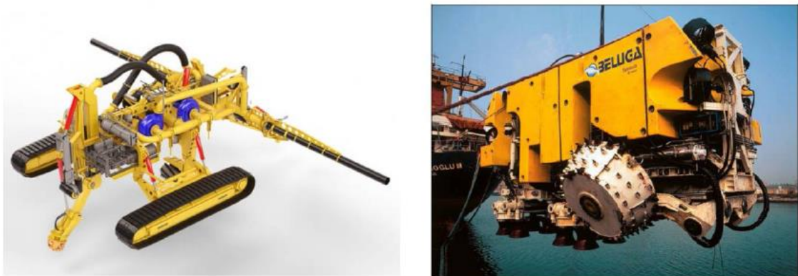
Figura 4.15: Esempio di Mezzo Sottomarino Tradizionale per Operazione di Interrimento della Condotta con Post trenching”
