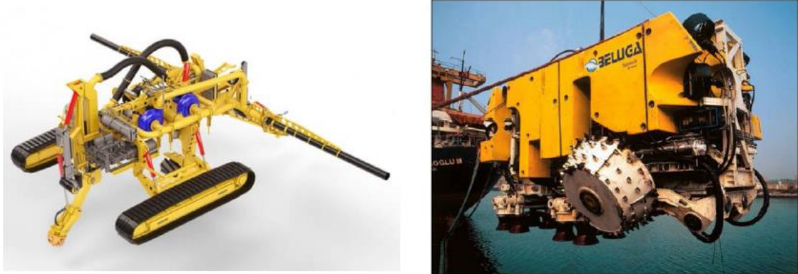
Figura 2.16: Esempio di Mezzo Sottomarino Tradizionale per Operazione di Interramento della Condotta con Post trenching”
