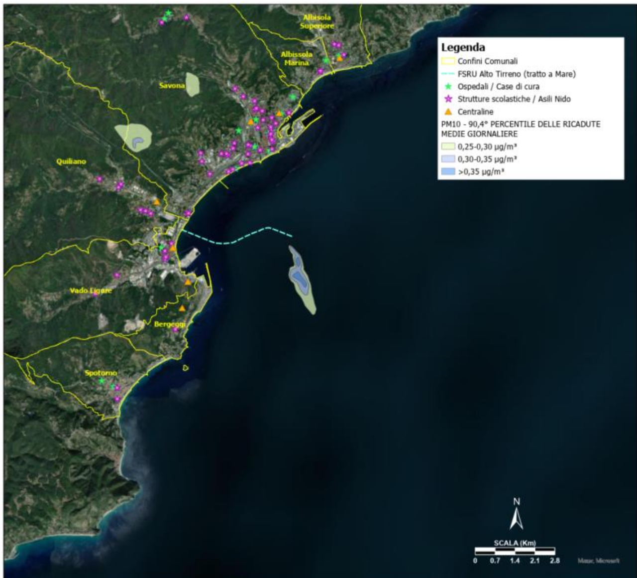
Figura 4-9: Scenario Massimo - 90,4 percentile delle concentrazioni medie giornaliere di PM10 (Valore Limite: 50 \mu\text{g}/\text{m}^3 da non superare più di 35 volte in un anno)
