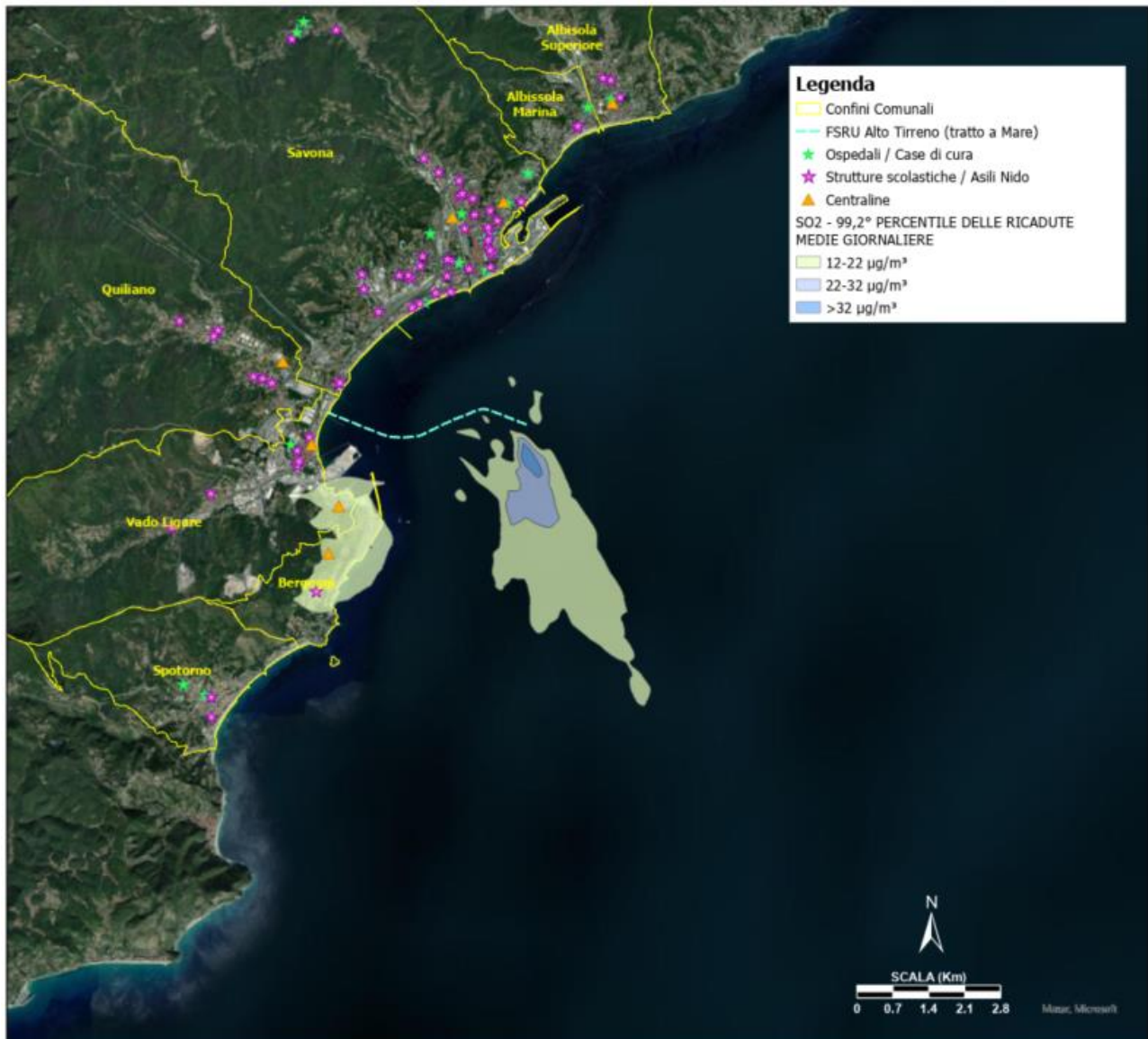
Figura 4-15: Scenario Massimo - 99,2° percentile delle concentrazioni medie giornaliere di SO 2 (Valore Limite: 125 \mu\text{g}/\text{m}^3 da non superare più di 3 volte in un anno)
