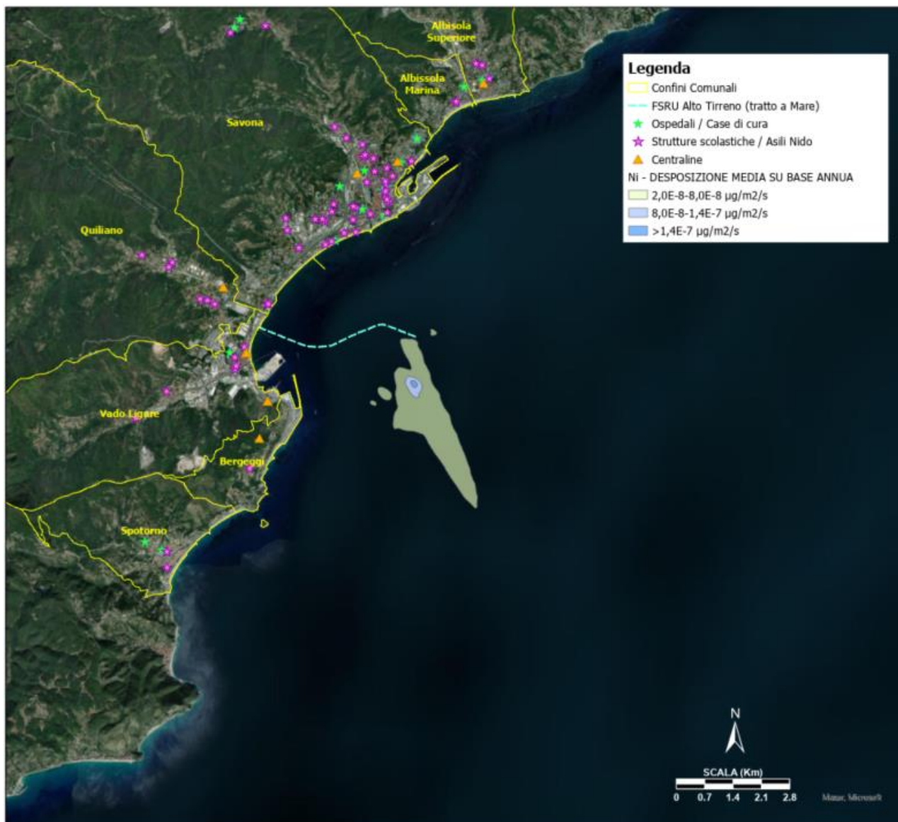
Figura 4-24: Scenario Medio Annuo – Deposizione media su base annuale di Ni (Valore di Riferimento: 15 µg/m2/gg)
