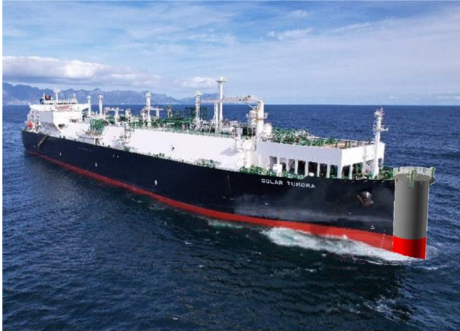
Figura 2.4: FSRU Golar Tundra con turret buoy
