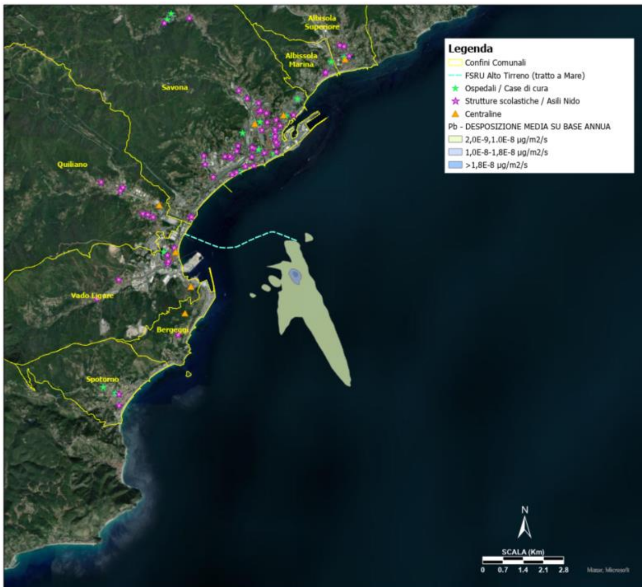
Figura 4-22: Scenario Medio Annuo – Deposizione media su base annuale di Pb (Valore di Riferimento: 100 \mu\text{g}/\text{m}^2/\text{gg} )
