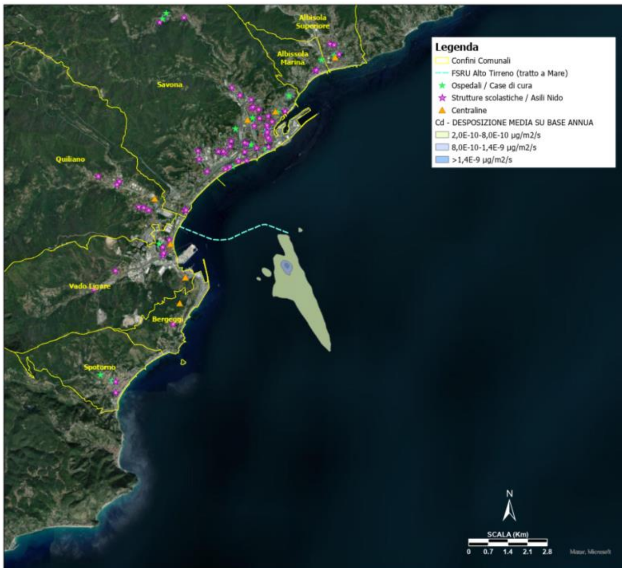
Figura 4-23: Scenario Medio Annuo – Deposizione media su base annuale di Cd (Valore di Riferimento: 2 \mu\text{g}/\text{m}^2/\text{gg} )
