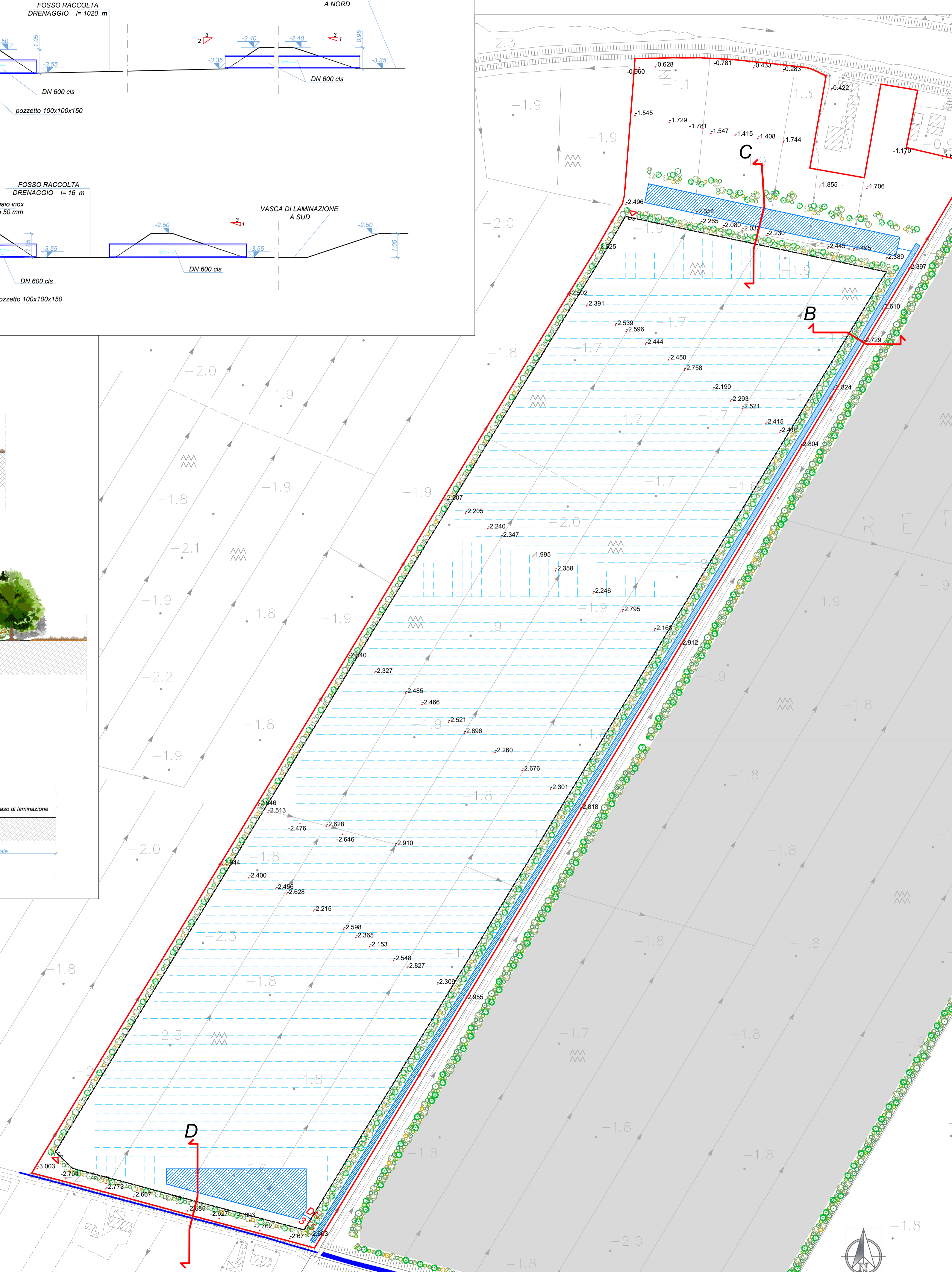
PLANIMETRIA IMPIANTO FOTOVOLTAICO SC. 1:2000
